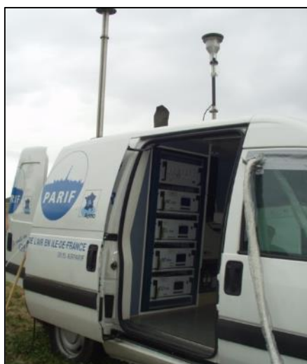
Figure A1 1 : Exemple d'un laboratoire mobile accueillant des analyseurs permettant les mesures horaires de la qualité de l'air de manière automatique
