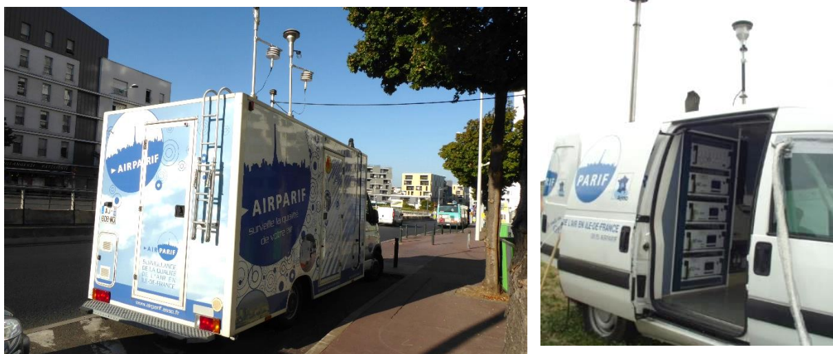
Figure 32 : Laboratoire mobile et exemple d'un laboratoire mobile accueillant des analyseurs permettant les mesures horaires de la qualité de l'air de manière automatique
